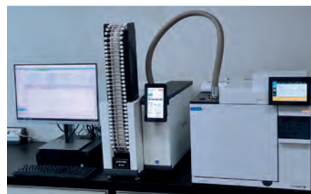
Obr.: Automatizovaná multi termální desorpční jednotka APK720R napojená na GC systém
