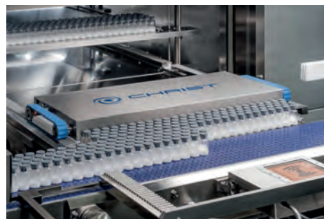
Obr. 10: Vykládací zařízení CHRIST pro vialky pro výrobní lyofilizátor
