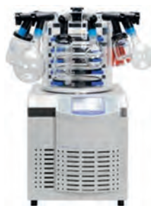
Obr. 3: Laboratorní lyofilizátor CHRIST Alpha 2-4 LSCbasic
