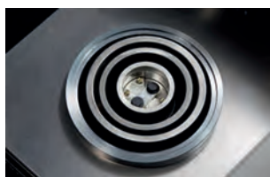
Obr. 3: Rovnoměrné rozložení toku tepla mezi pozici referenční a vzorkem
