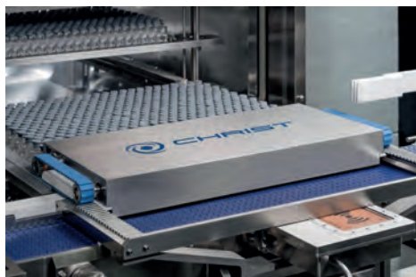
Obr. 9: Nakládací zařízení CHRIST pro vialky pro výrobní lyofilizátor
