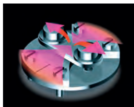
Obr. 3: Rovnoměrné rozložení toku tepla mezi pozici referenční a vzorkem
