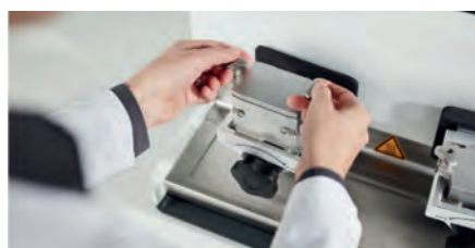
Obr. 2: S inovativními šroubovacími mlecími nádobami se lehce manipuluje a upnuty jsou během několika sekund
