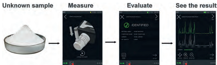
Obr. 2: Proces analýzy na BRAVO – změřit, vyhodnotit, zobrazit výsledek
