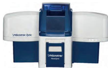
Obr. 6: Synchronní analýza velikosti a tvaru částic: Přístroj Microtrac Sync poskytuje simultánně veškeré informace o měřeném vzorku, vzorek je analyzován jak laserovou difrakcí i dynamickou obrazovou analýzou.
