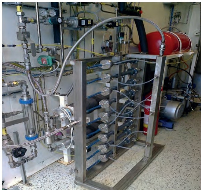
Obr. 5: Sestava paralelně zapojených membránových modulů P2 v pilotní jednotce
