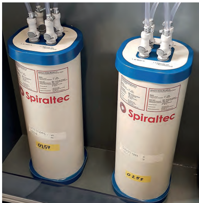
Obr. 2: Fotografie modulů WD-AR 10 výrobce Spiraltec s napojením nástříku, vody, difuzátu a dialyzátu. Rozměry modulu jsou (š×d×v) 20×20×60 cm, plocha membrány je 6 m 2
