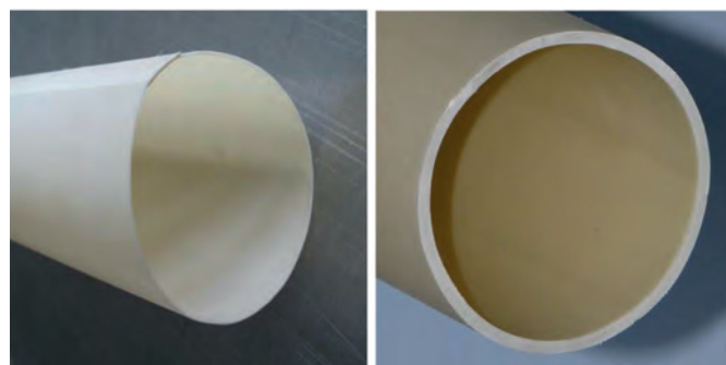
Obr. 2: Porovnání svařované Ralex® AMH5HD (vlevo) a Ralex® AM-XT Tubular (Křivčák 2015)
