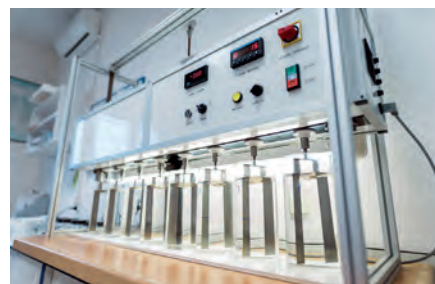
Obr. 2: Laboratorní míchací jednotka slouží k výzkumu tzv. koagulace při úpravě vody (Foto: Viktor Černocho, Divize vnějších vztahů SSČ AV ČR)
