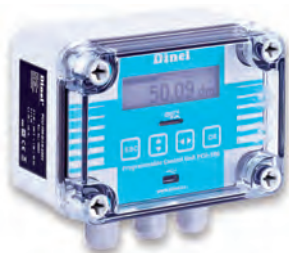
Obr. 5: Univerzální datalogger PCU-100 s grafickým displejem
