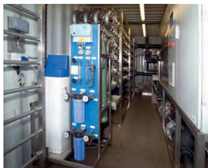
Obr. – Zařízení Axiom Process CMT pro odstraňování mikroplastů z odpadních vod pomocí membránové technologie
