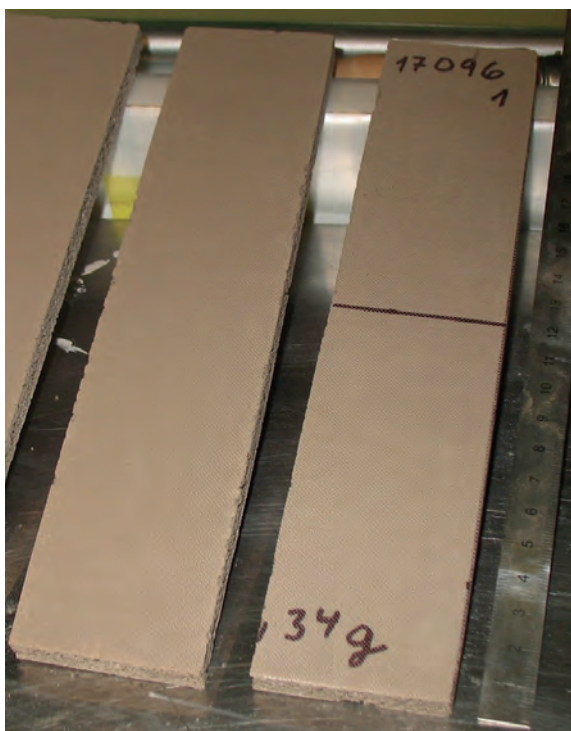
Obr. 1 – Vzhled těles vyříznutých z geopolymerní pěnové desky o objemové hmotnosti 400 \text{ kgm}^{-3}
