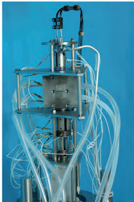
Obr. – Trochoidální elektronový spektrometr, který slouží k výzkumu nízkoeenergetických elektronových srážek
