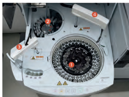
Obr. 3: Pohled do modulu CLAM-2030. 1. Karusel pro vzorky a reagenty. 2. Rack pro vialky 3. Nástřiková jehla vzorku 4. Nástřiková jehla reagentu
