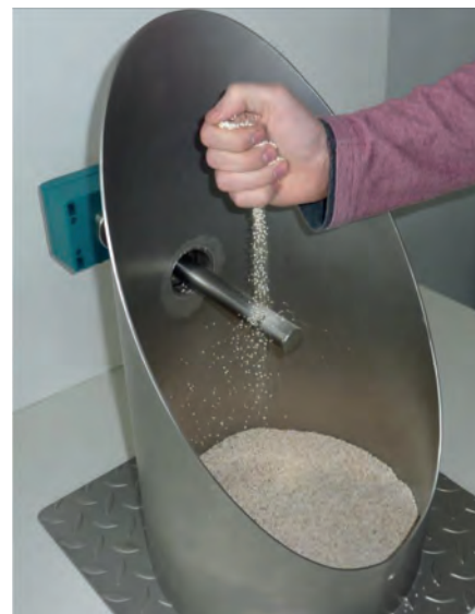
Obr. 2 – Senzor IPP 75-S je do nádoby umístěn přímo v hlavním proudu částic
