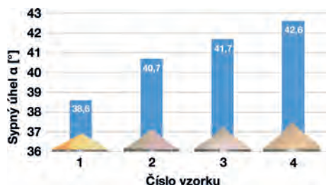
Obr. 5 – Hodnoty sypných úhlů, metoda Zenegera
