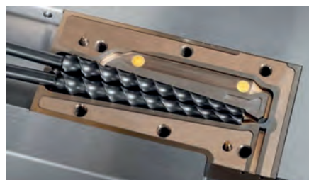
Obr. 2 – Spodní část komory se zpětným tokem a tlakovými snímači
