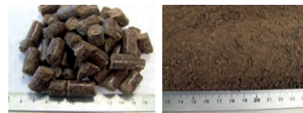
Obr. 4 – Lisovaná celulósová vláknitá rohož před a po zpracování v mlýnu SM 400 XL
