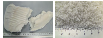
Obr. 5 – Krmné pelety pro koně před a po zpracování v mlýnu SM 400 XL
