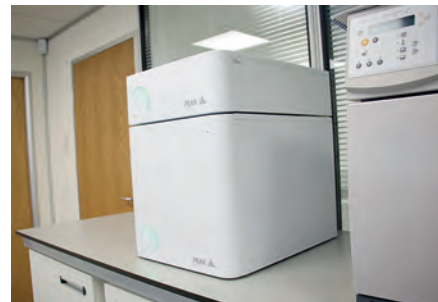
Obr. – Instalace generátor dusíku Solaris XE v laboratoři
