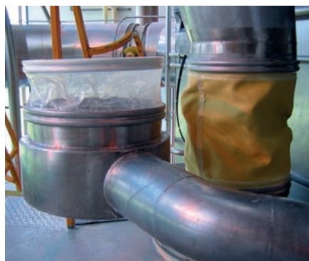
Obr. 10: Záměna rukávu při CIP
