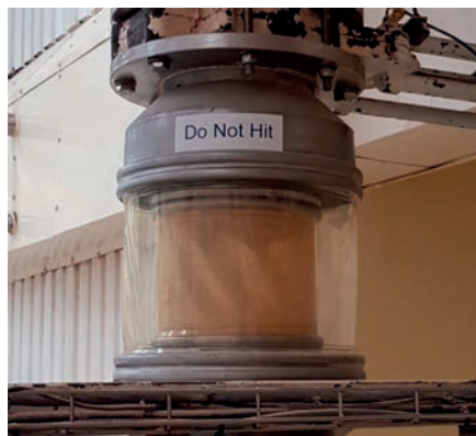
Obr. 9: Oddělení ex zón pomocí dvojitého spoje
