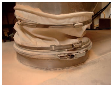
Obr. 2: Porovnání hadicových spon a systému BFM Fitting
