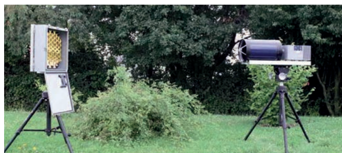
Obr. 1: Přístroj OPS pro dálkovou analýzu plynů
