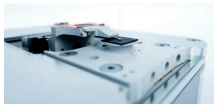
Obr. 1: Inovativní mikroskop atomárních sil LiteScope™ vyvinutý firmou NenoVision
