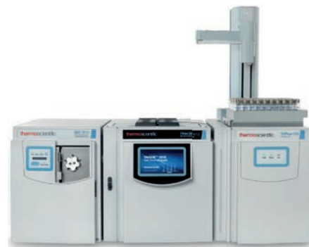
Obr. 4: Sestava GCMS na nové platformě TRACE 1610 a ISQ 7610 s předřazeným headspace dávkováním pomocí autosampléru TriPlus 500
