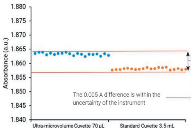
Obr. 4: Absorbance 20 opakovaných měření v 70 µl kyvetě ve srovnání s 20 měřeními ve standardní 3,5 ml kyvetě
