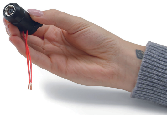
Obr. 2: Plasmion SICRIT® - iontový zdroj na bázi studené plasmny
