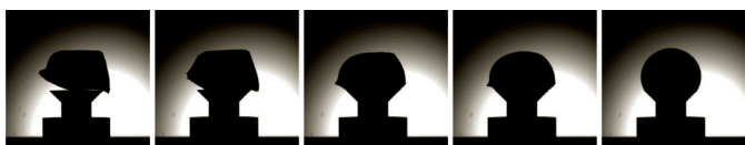
Obr. 4: Tavení vzorku mědi na podstavci ze ZrO 2
