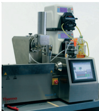
Obr. 1: Dávkování prášků a kapalin do extruderu
