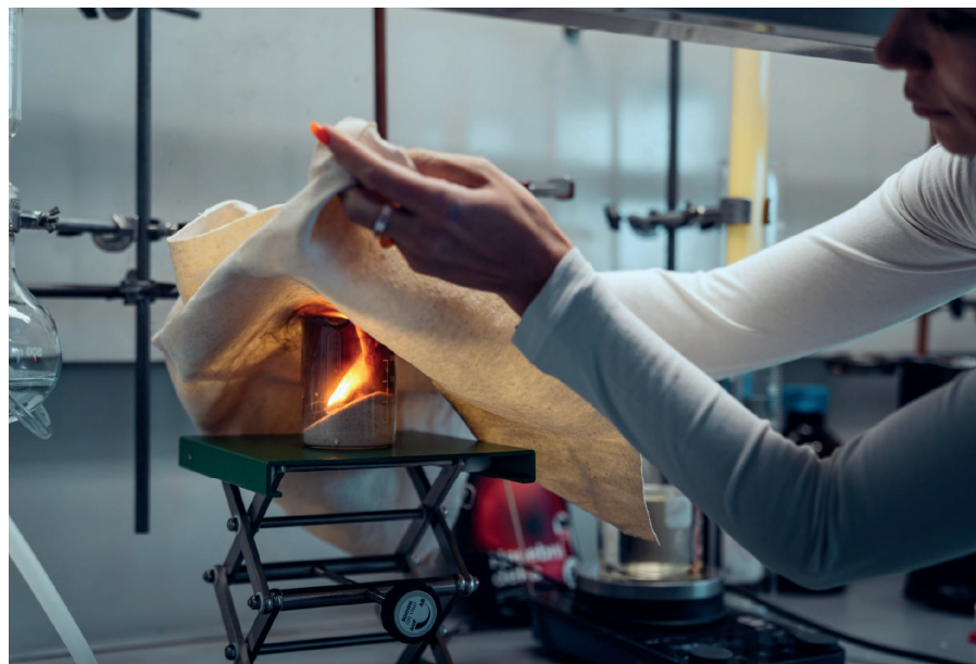
Obr. 2: Hašení vzníceného vzorku v laboratoři.
