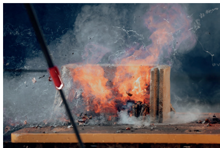
Obr. 5: Testování Foga na zábavní pyrotechniku.
