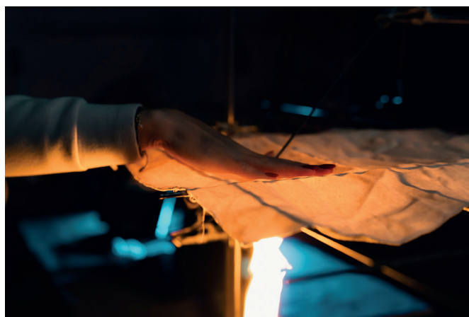
Obr. 4: Měření robustnosti tepelné bariéry Foga
