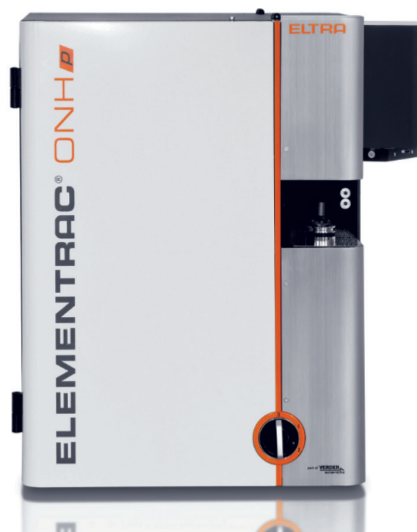
Obr. 5: Otvor na vzorky a pec analyzátoru ELEMENTRAC ONH-p 2
