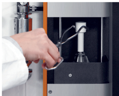
Obr. 2: Umístění vzorku s urychlovačem na podstavec přístroje ELEMENTRAC CS-i.
