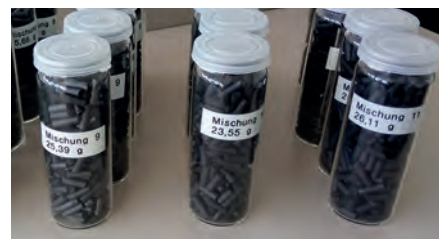
Obr.: Kompozit s aktivním uhlím má elektrickou vodivost třikrát vyšší než konvenční granulované aktivní uhlí
