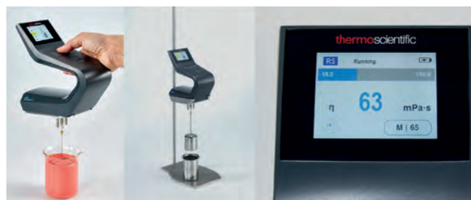
Obr. 1: Thermo Scientific™ HAAKE™ Viscotester™ 3 – viskozimetr jako ruční zařízení (vlevo), s laboratorním stojanem (uprostřed) a podrobným zobrazením displeje s naměřenou hodnotou a porovnávacím s referenční hodnotou (vpravo)
