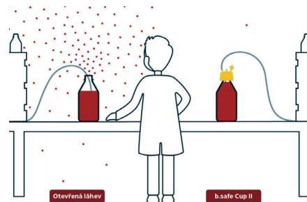
Obr. 3: Snížení kontaminace vzduchu výparů díky použití b.safe
