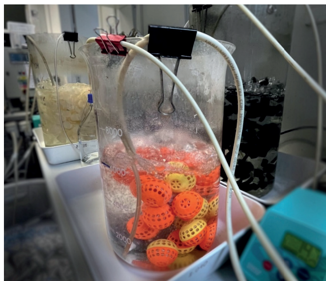
Obr. 3: Testování inovativních nosičů biomasy v laboratorních bioreaktorech.
