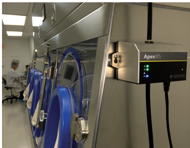
Obr. 1: Instalace prachového čidla Lighthouse APEX R5 v izolátoru.
