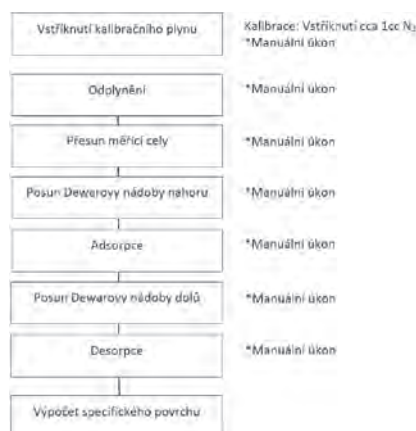
Obr. 2: Postup měření u konvenčních BET analyzátorů
