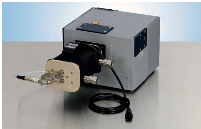
Obr. 2: Přístroj OPS pro dálkovou analýzu plynů
