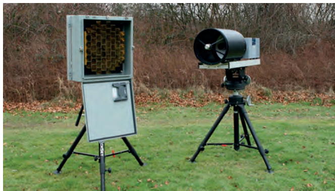
Obr. 2: Přístroj OPS pro dálkovou analýzu plynů
